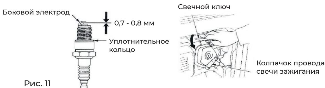
**8.3.1.** Сначала очистить грязь вокруг свечи зажигания, затем снять колпачок провода свечи зажигания и с помощью гаечного ключа извлечь свечу зажигания.
